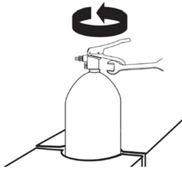
Figura 3: Desmontagem conjunto válvula
