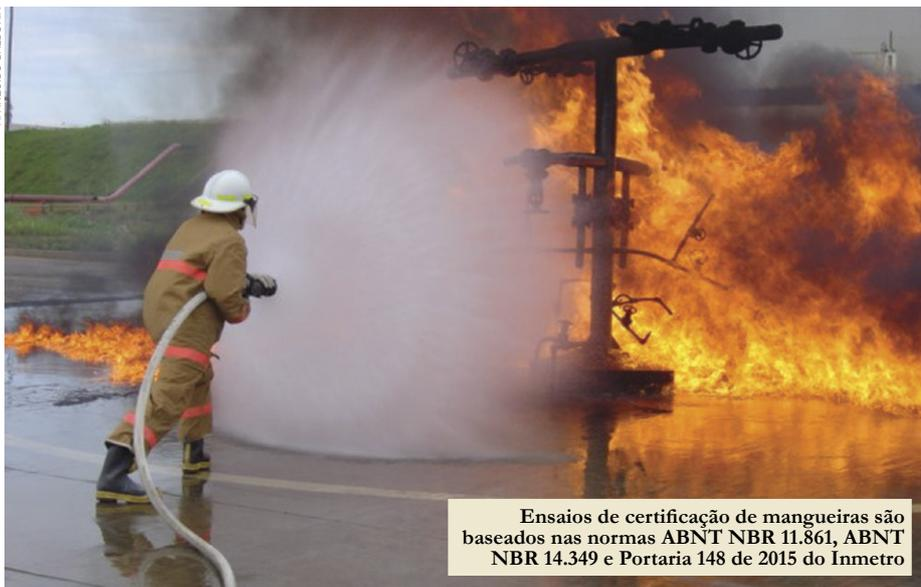
Ensaio de certificação de mangueiras são baseados nas normas ABNT NBR 11.861, ABNT NBR 14.349 e Portaria 148 de 2015 do Inmetro
